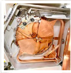
(圖二) 世界唯一供臨床使用的solidtarget迴旋加速器，和合成器
